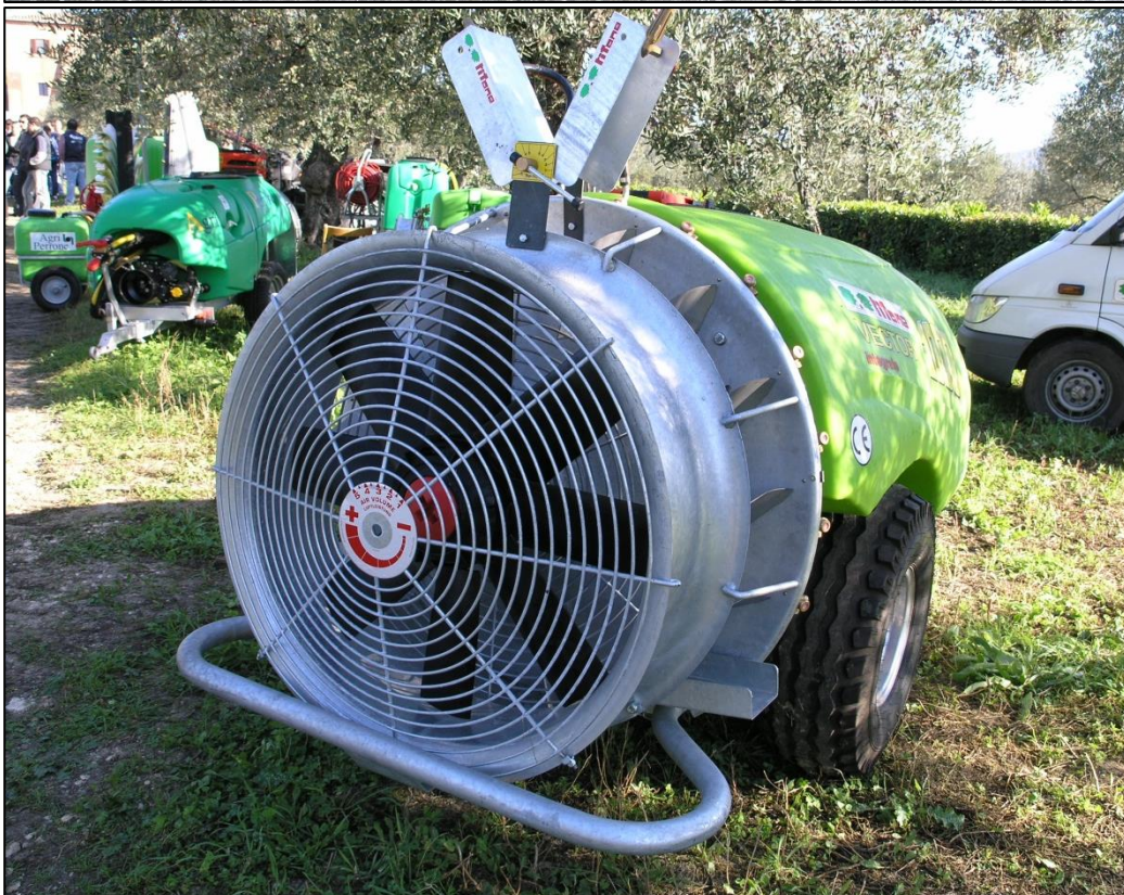
La protezione della ventola dell'atomizzatore è giudicata idonea se non permette il contatto di alcuna parte del corpo con le parti in movimento.
