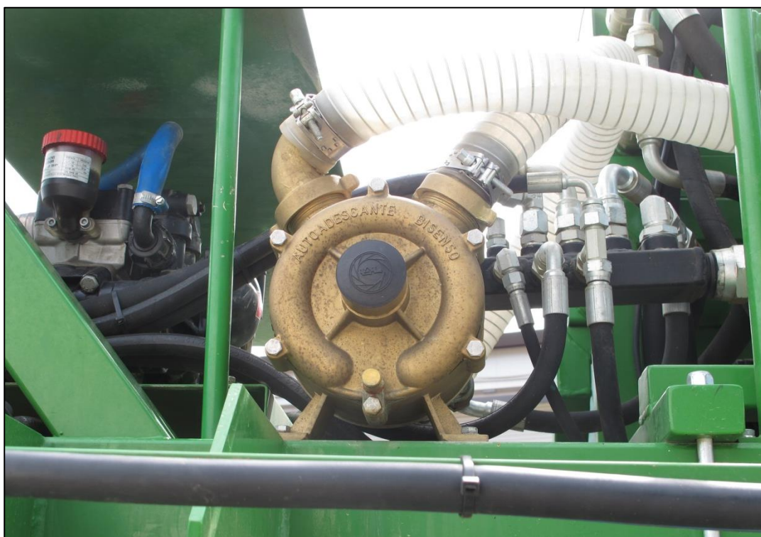
Pompa centrifuga ausiliaria di un'irroratrice semovente per il caricamento dell'acqua per la miscela fitosanitaria da corpi d'acqua o vasche di accumulo.
