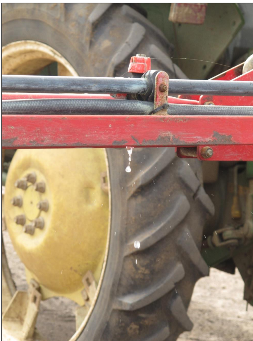
Evidente gocciolamento da una tubazione in prossimità del portaugelli.
