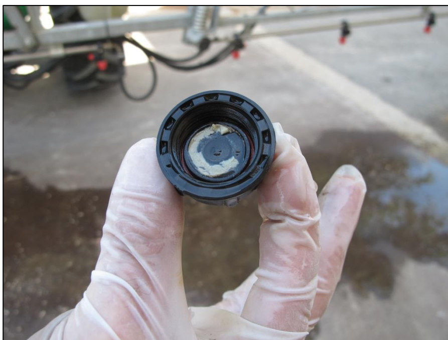
Cattivo stato di pulizia del dispositivo antigoccia dell'ugello.
