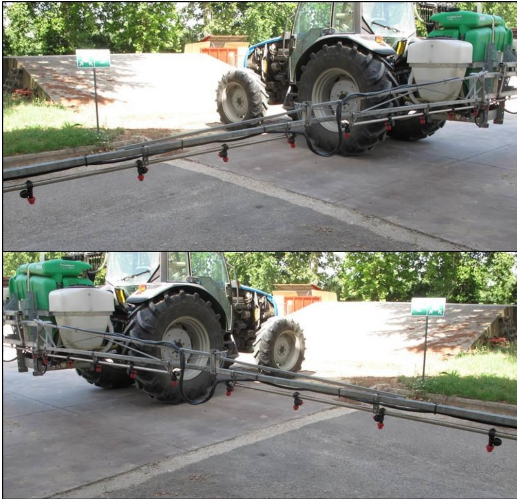
Simmetria della barra tra parte destra e sinistra.
