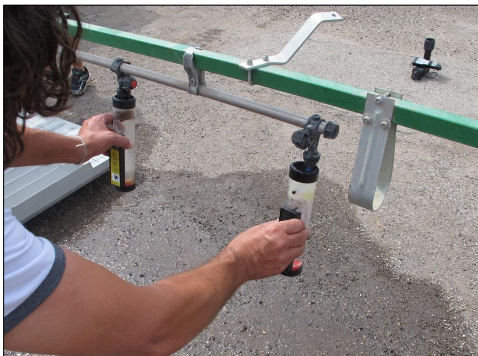
Controllo speditivo della portata tramite flussimetri elettronici.
