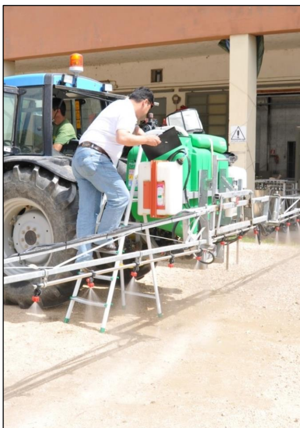
Verifica visuale della portata della pompa: il tecnico accerta l'effettivo ricircolo all'interno del serbatoio durante l'irrorazione.
