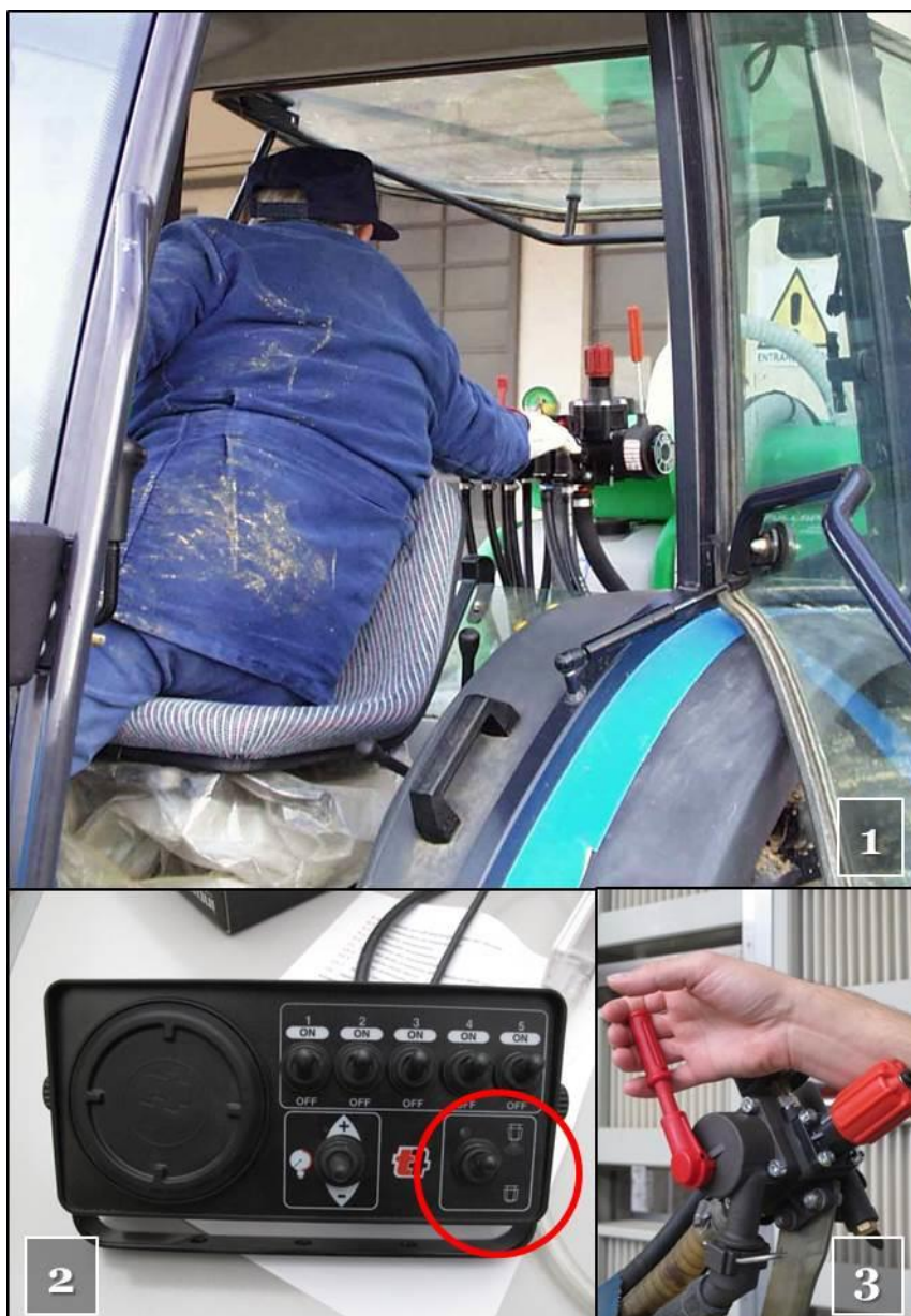
Le valvole per il comando delle sezioni idrauliche della barra sono raggiungibili senza che l'operatore debba alzarsi dal sedile di guida (1). Valvola elettrica su gruppo di controllo (2). Comando on-off manuale di un atomizzatore (3).
