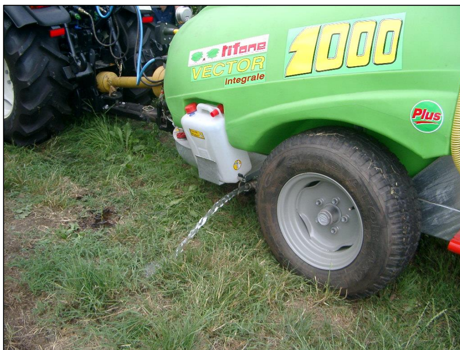
Rubinetto di svuotamento del serbatoio opportunamente collocato.
