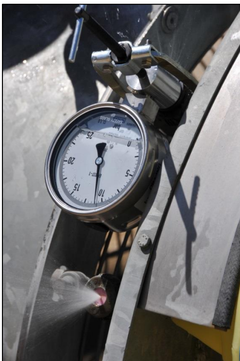
Posizionamento del manometro di controllo durante una verifica della caduta di pressione di un atomizzatore (a sx). Portaugello con attacco predisposto per la verifica della pressione (a dx).
