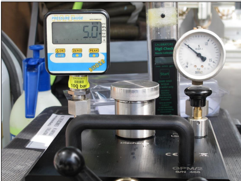
Controllo della precisione del manometro tramite banchetti prova a torchio idraulico, dotati di manometro di riferimento analogico o digitale.
