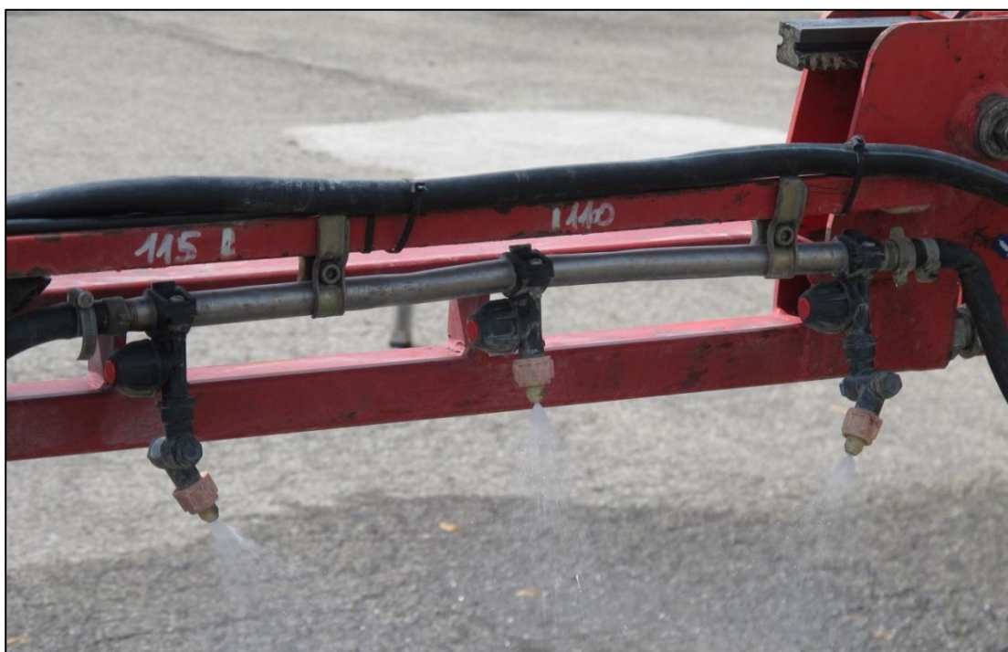
Anche nel caso delle barre per trattamenti in banda, gli ugelli e i componenti devono essere uguali, pur presentando un diverso orientamento.
