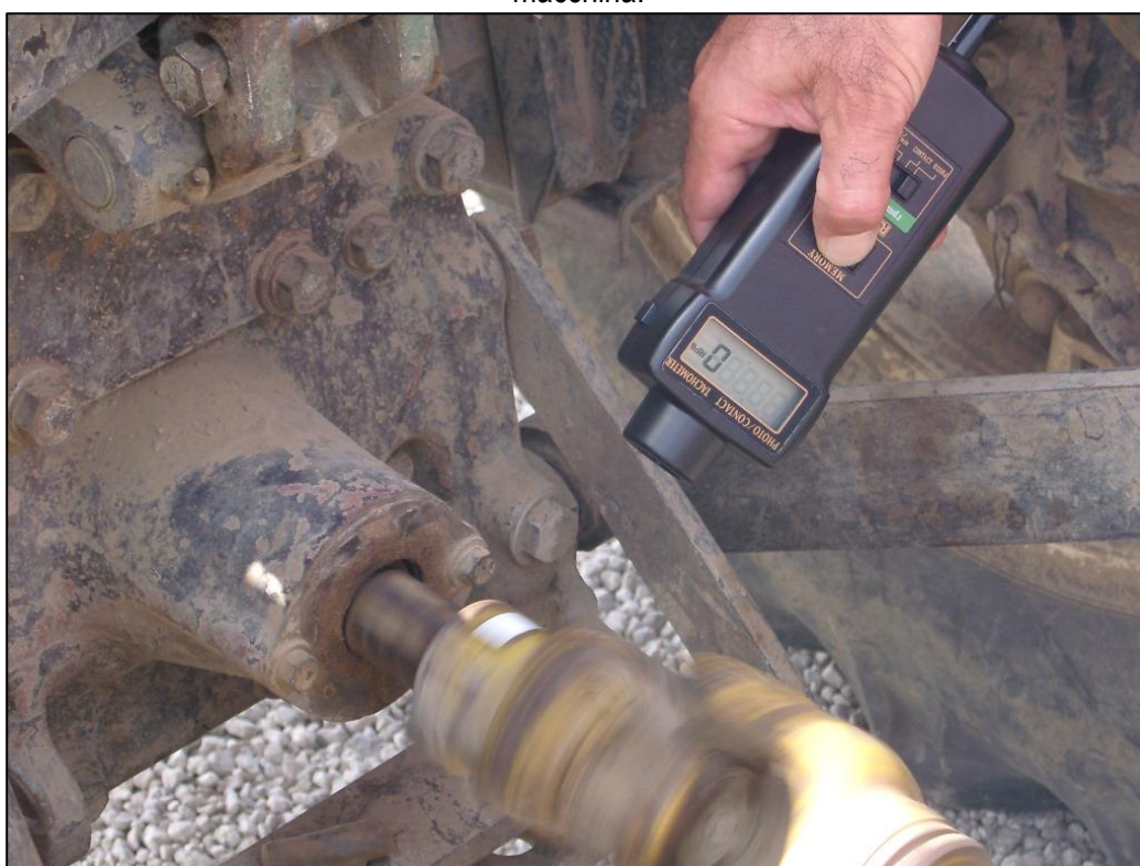
Elementi di trasmissione scoperti durante la verifica della velocità di rotazione della p.d.p. mediante tachimetro ottico.
