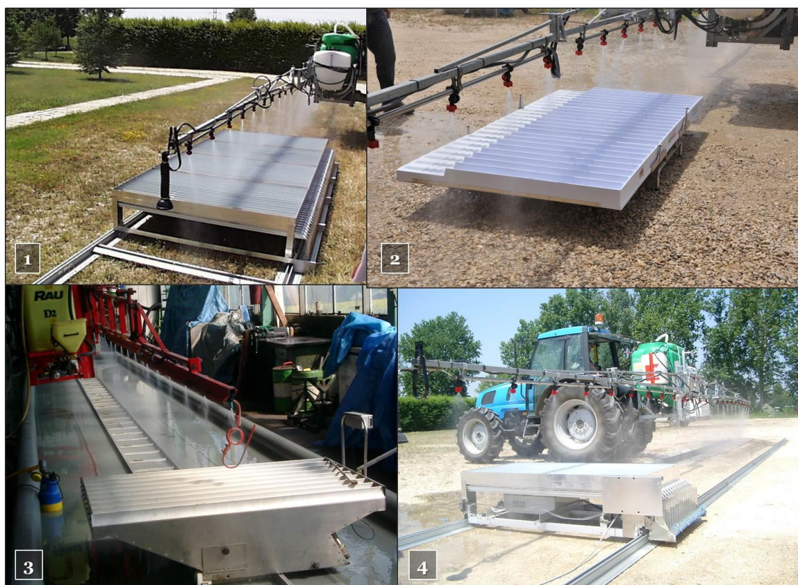
Diversi tipi di banco prova utilizzati nelle verifiche dell'uniformità di distribuzione trasversale. 1) Banco a canalette in acciaio, con canalette distanti 50 mm; 2) banco a canalette in plastica, con canalette distanti 100 mm; 3 e 4) banchi tipo "scanner" con acquisizione automatica dei dati raccolti.
