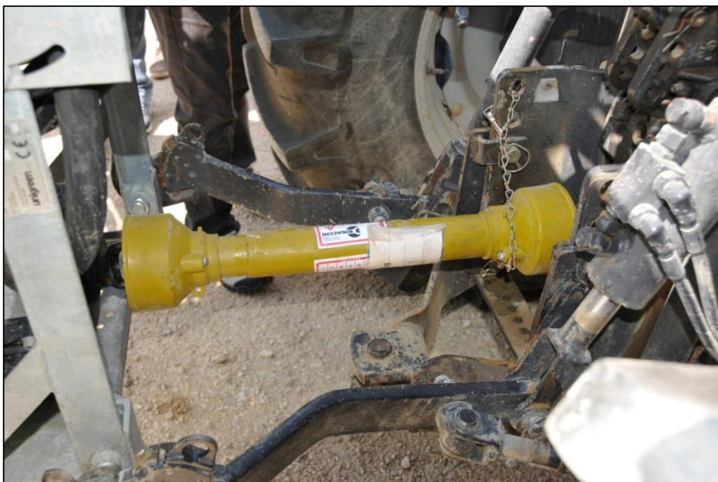
Elementi di trasmissione parzialmente protetti, mancano le cuffie di protezione sul trattore e sulla macchina.
