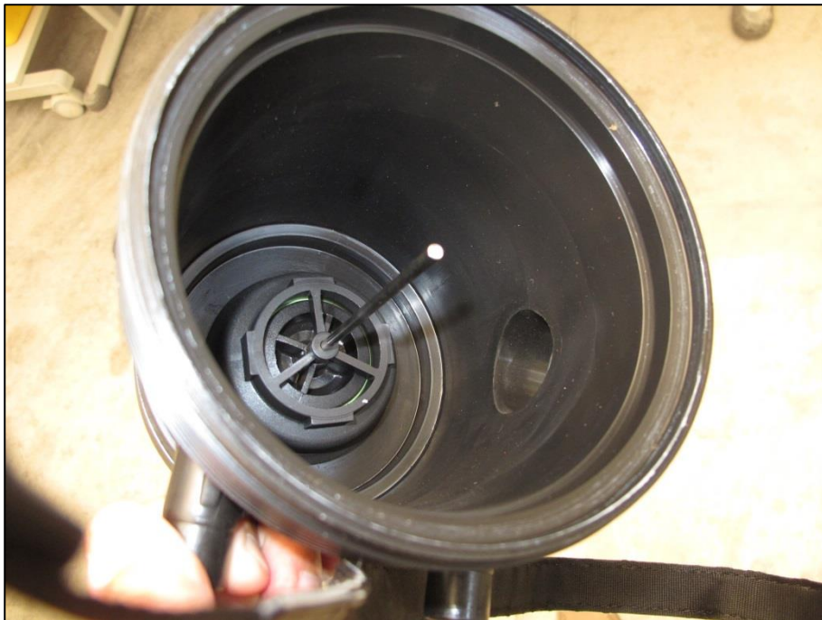
Particolare del sistema di isolamento del filtro.
