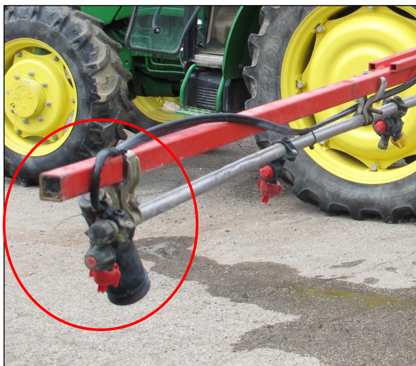
Mancanza di protezione di fine barra: l'erogatore della schiumogeno non può essere considerato come protezione.
