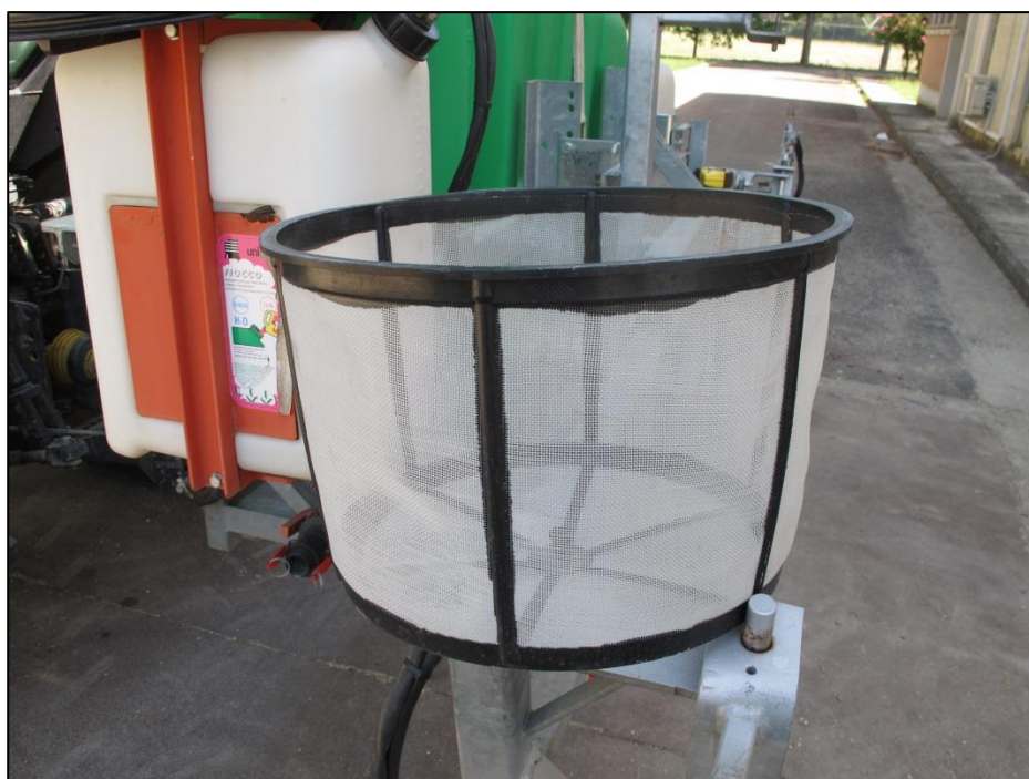
Filtro a cestello del serbatoio principale.
