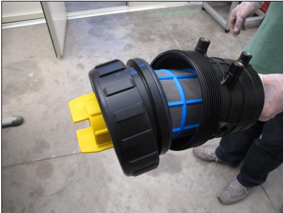
Filtro principale con il sistema di isolamento.
