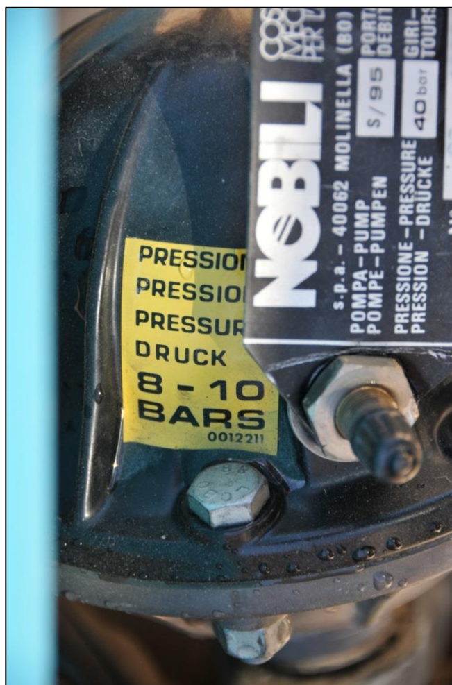
Compensatore idropneumatico con la targhetta che riporta il valore di pressione per il suo gonfiaggio.
