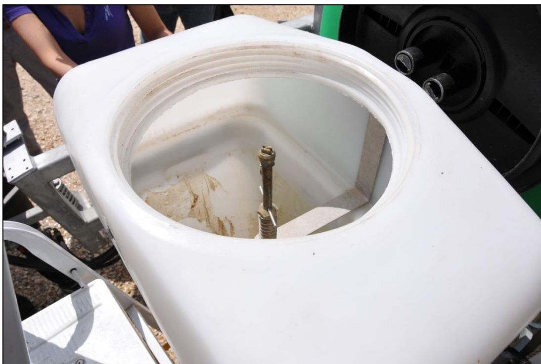
Ugello lava contenitori ubicato nel serbatoio accessorio di premiscelazione.
