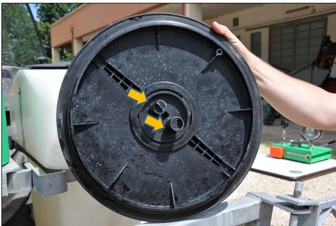
I fori per la compensazione della pressione del tappo del serbatoio principale.
