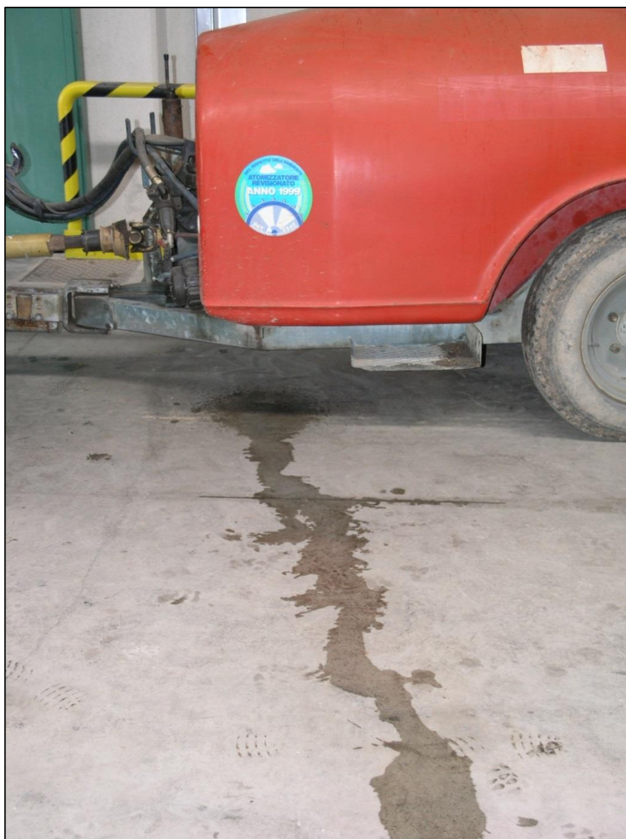
Vistosa perdita dal serbatoio principale.
