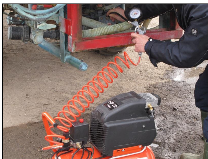
Controllo della pressione e caricamento del compensatore idropneumatico.
