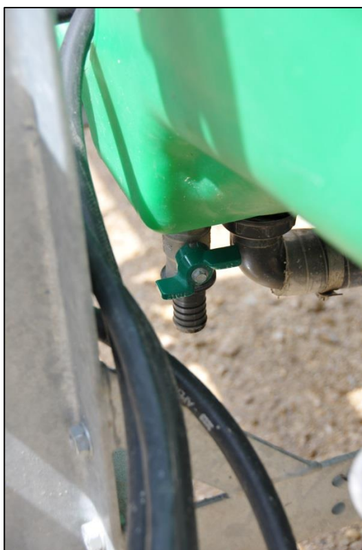
Rubinetto di svuotamento del serbatoio principale di una barra.
