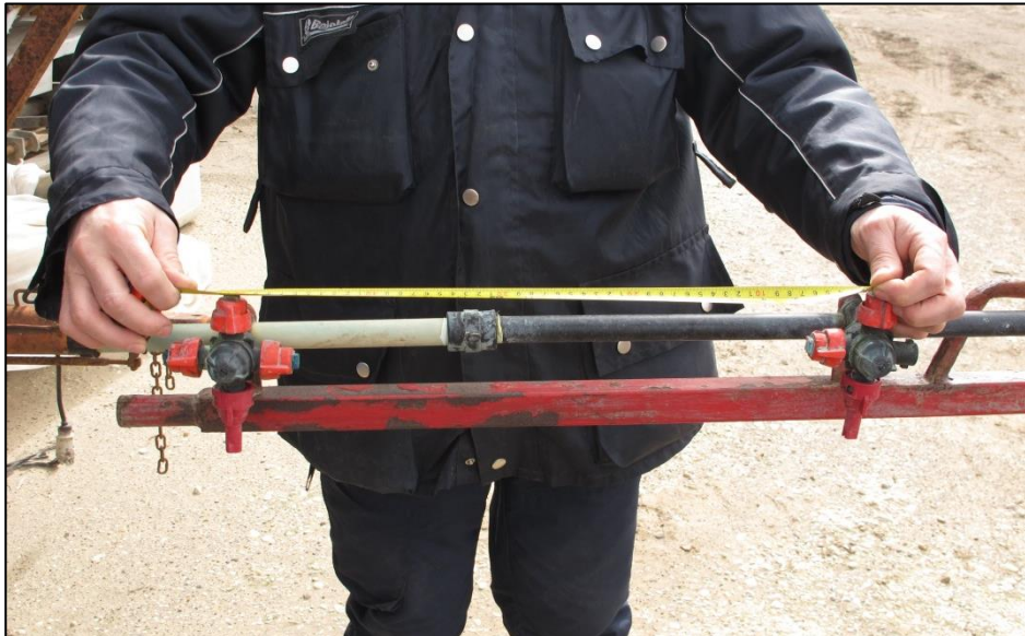
Verifica della distanza tra gli ugelli sulla barra.
