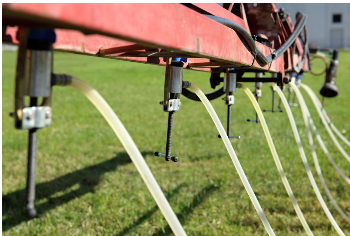
Adattatori a pinza per il collegamento al banco controllo portata con tubi graduati.
