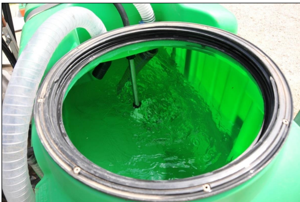
Un buon ricircolo è visibile all'interno del serbatoio.
