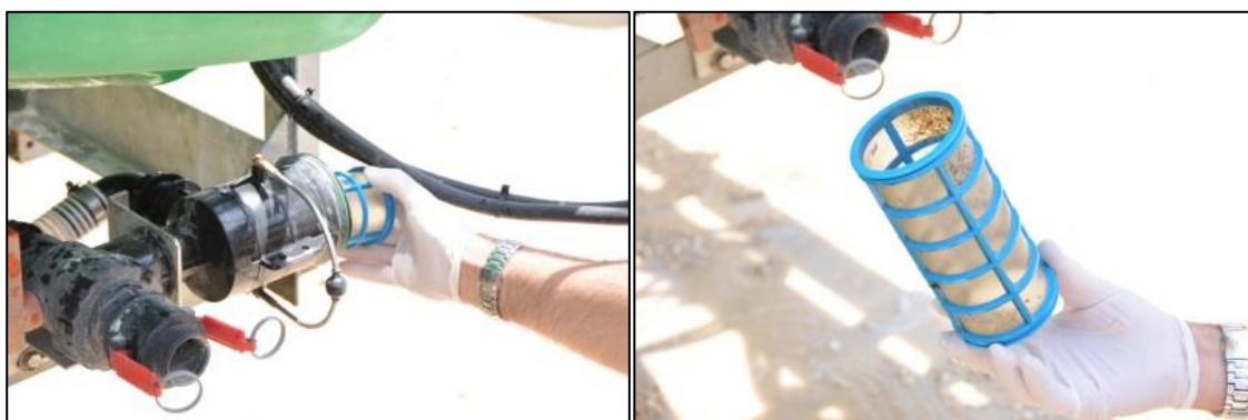
Ispezione del filtro alla mandata: il filtro si presenta in buone condizioni ma sporco.
