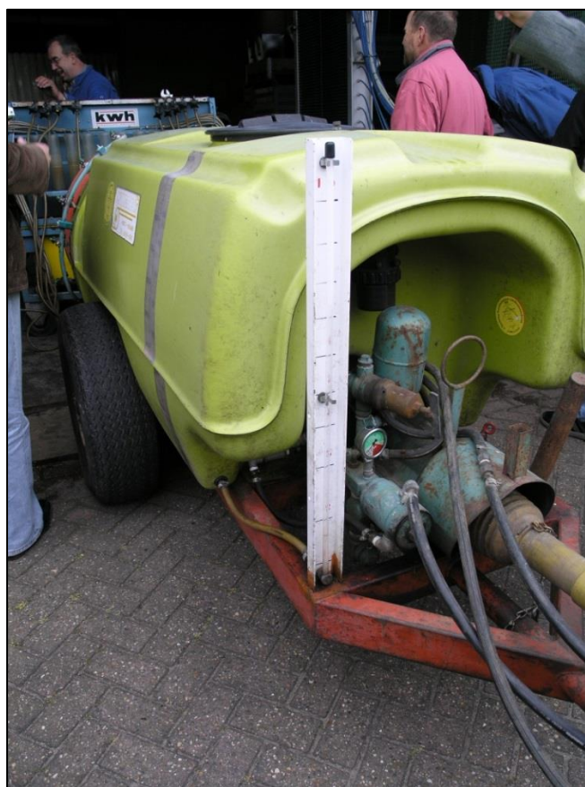
Indicatore del livello del liquido aggiunto su una macchina dove ne era stata riscontrata la mancanza.
