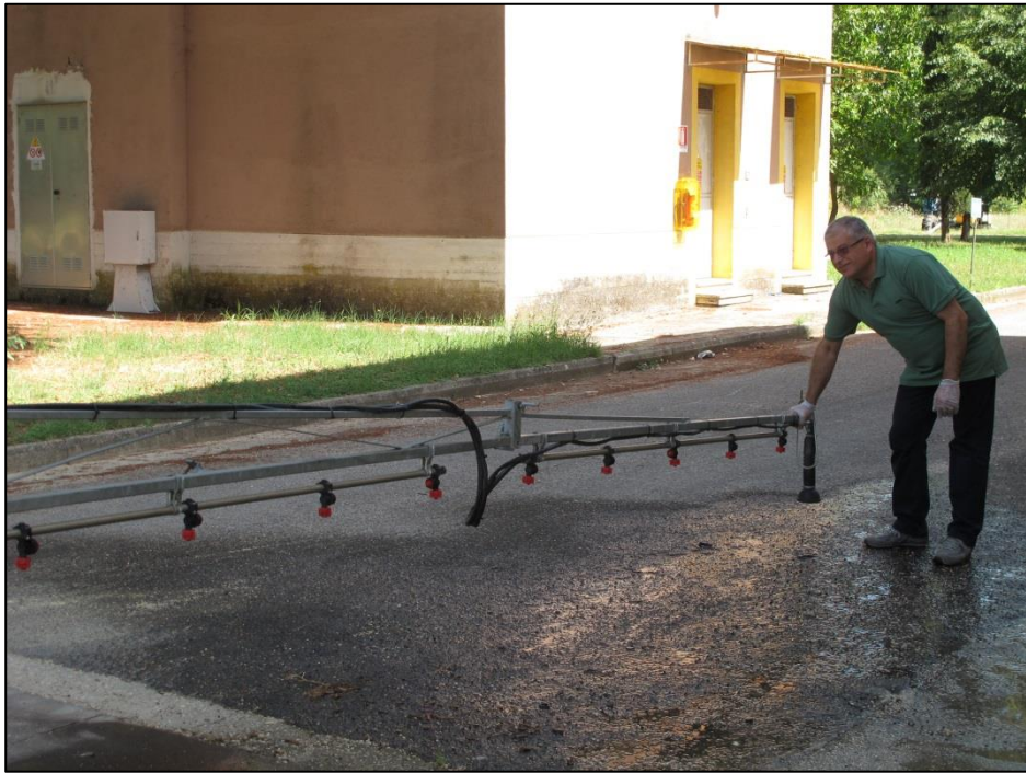
Controllo manuale della stabilità della barra.
