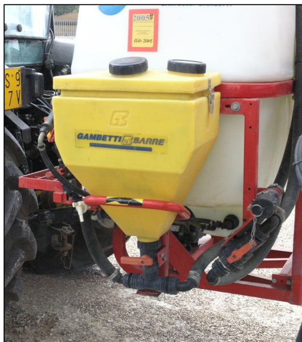
Serbatoi di premiscelazione.
