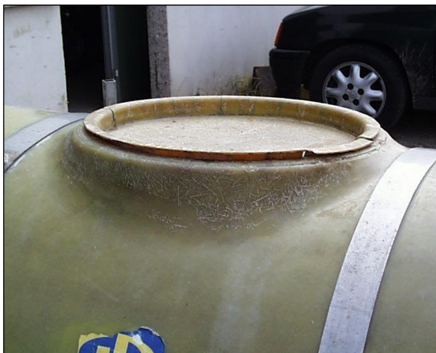
Tappo che non assicura la compensazione della pressione.
