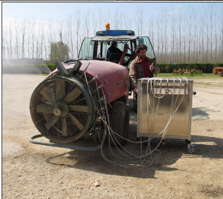
Misura della portata degli ugelli mediante banco prova con cilindri graduati
